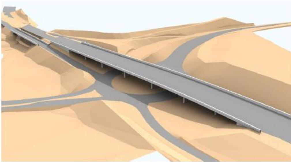
**Abb. 2.14:** 3D-Visualisierung «Vollanschluss an A18», Aesch, was baulich möglich ist. Der Kreislauf des Vollanschlusses kommt im Gebiet Wyden in Aesch auf eine Ebene unter der A18 (H18) zu liegen. Beim Bahnhof Grellingen wäre der Auto-Kreislauf oben. Was in Aesch, Pratteln etc. geht - soll in Grellingen, in einfacherer Form, nicht gehen? ...
