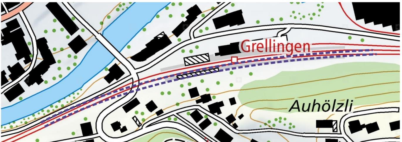
**Abb. 2.3: «Variante Pfeffingen 2»**, Optimierungsvorschlag zu Variante «Pfeffingen» (Abb. 2.2): Geleise bei den Perrons ca. 5 m nach Süden verschieben, im Zusammenhang mit dem Doppelspurausbau = besserer Kurvenradius, auf der Schiene kann schneller gefahren werden (blau gestrichelt). Mit Stützmauer auf der Hangseite. So kann auch der Strassenverkehr nördlich der SBB künftig gut platziert werden. ... oder den alten Bahnhof einfach abreißen.
